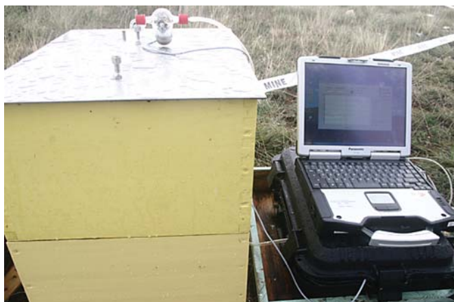
Slika 6. Povezivanje košnice s elektroničkim nosom
