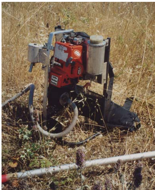
Slika 3. Prijenosni usisivač za uzimanje uzoraka pogonjen benzinskim motorom
