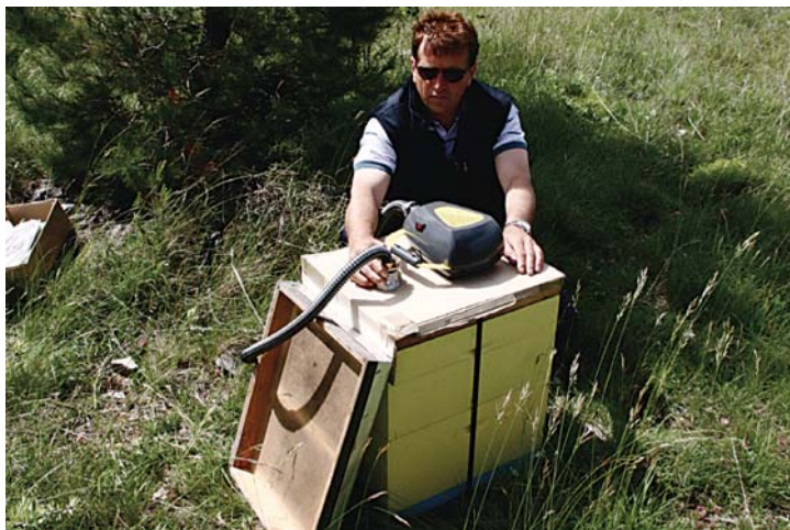
Slika 4. Uzorkovanje zraka iz košnice na filter od staklenih vlakana
